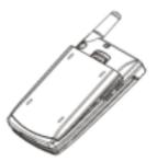
SIM 卡应该面向移动电话,注意 SIM 卡缺角位置与 SIM 卡座上缺角位置相对应。
